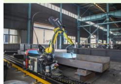
随着建筑钢结构行业的快速发展,大跨度、场馆类、超高层建筑钢结构越来越多,构件类型也日趋复杂,其设计、制作精度要求较高。目前,焊接手工操作的低效率和质量的不稳定往往成为生产效率的提高和产品质量稳定性的最大障碍。钢结构制造企业的焊接水平特别是自动焊水平的提高,是实现钢结构技术快速发展的关键所在。建筑钢结构制造行业虽然焊接工作量很大,但由于目前我国建筑钢结构多是非标设计、构件品种多、单件小批量生产、工艺复杂,再加上前道工序下料、组装精度不高等特点,实现全自动化焊接存在着较大困难。但是钢结构制造行业先进焊接技术的不断革新及高效智能焊接设备的应用,正逐步提升着钢结构的质量。华星钢构为了跟上智能化
