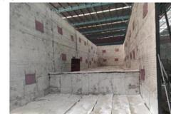
工件在进行热处理前需要对工件进行焊前预热和后热,而焊前预热和后热是为了降低焊缝的冷却速度,防止接头生成淬硬组织,产生冷裂纹。焊前预热温度一般在100-200℃,后热不属于热处理,只是一种缓冷措施,后热的温度在200-300度,有的单纯是为了缓冷,有的是针对消氢处理,一定的后热温度,能使焊缝中氢扩散出来,不至于集聚导致裂纹。且后热保温时间需要根据工件厚度来确定,一般不会低于0.5小时的。
